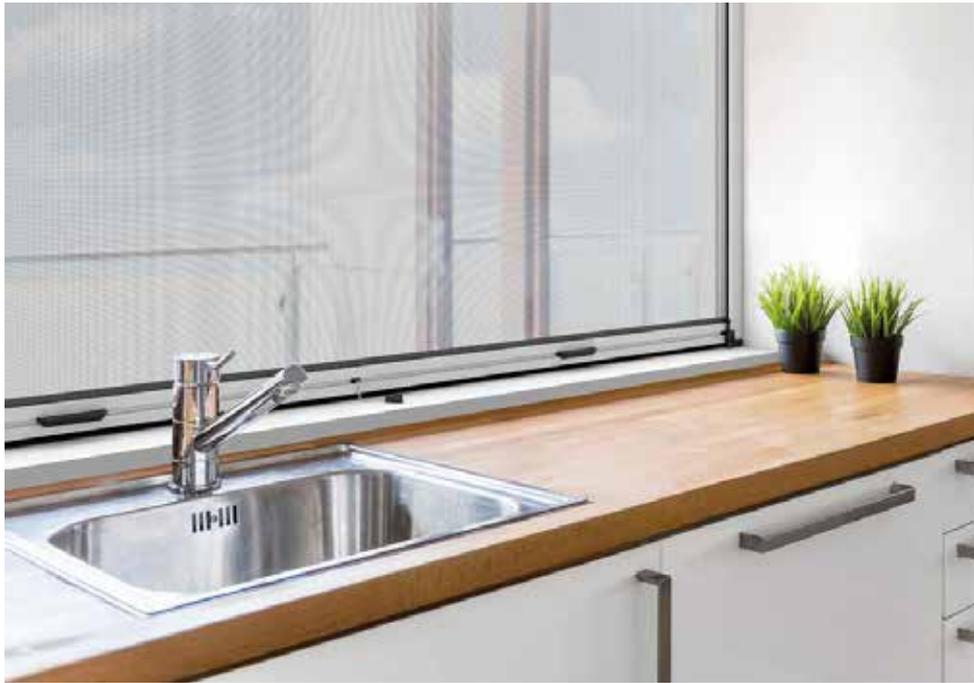
Pour éviter que le mécanisme de la moustiquaire enroulable ne se replie de façon rapide et brusque lors de l'enroulement, celui-ci incorpore un frein qui permet que cette action se fasse de manière progressive et douce.
